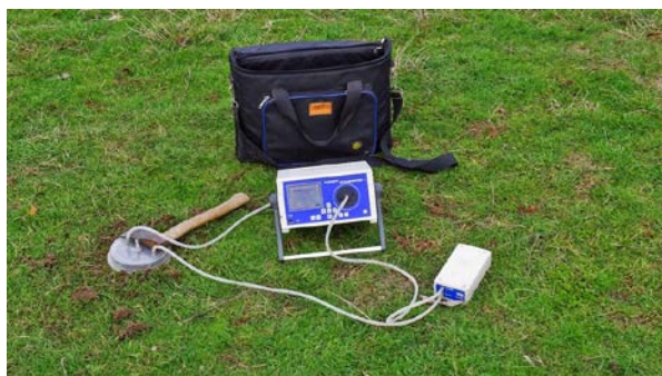
Радіометр радону «Альфарад+»
