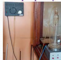
Крозон ОЗР-6У (проведення досліджень з деструкції органічних компонентів трапних вод АЕС озonom)
