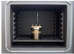
тефлоновий стакан і сталевий автоклав об'ємом 30 см 3 і автоклав в сушильній шафі (до 200 °С)
