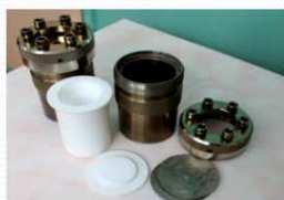
тефлоновий стакан і сталевий автоклав об'ємом 30 см 3 і автоклав в сушильній шафі (до 200 °С)
