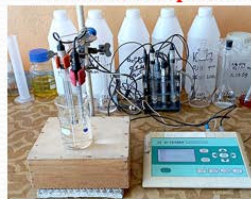
Іономір И160-МІ (визначення у водних розчинах рН, Eh, концентрації макроіонів Na + , Ca 2+ , K + , NH 4 + , NO 3 - , Cl - ,
