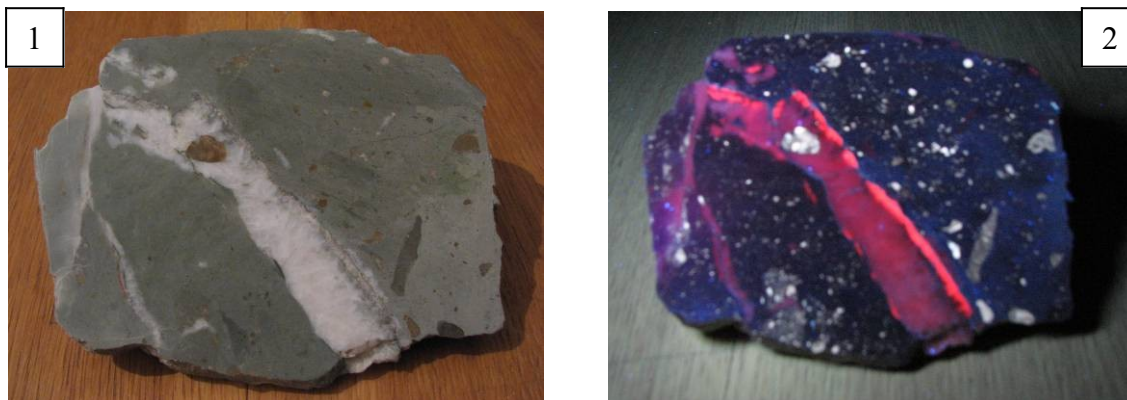
Рисунок 3.1 – 1. Светло-серый мраморизованный известняк при дневном свете. 2. Оранжевая люминесценция в мраморизованном известняке с примесью Mn
